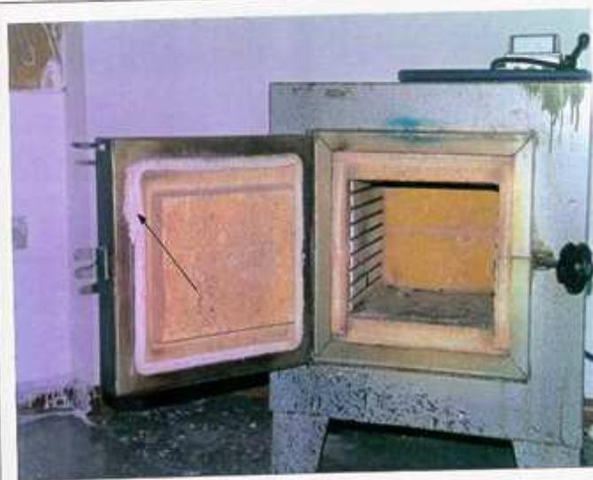
Foto 2: Mittelschule "Vigil Raber", Sterzing: Brennofendichtung
