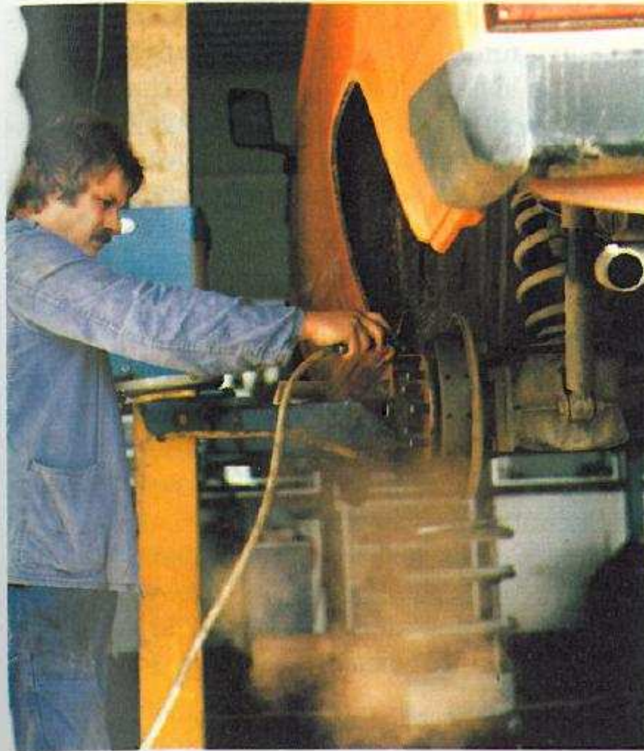
Abb. 16: Anwenderproblematik: Ein Kraftfahrzeug-Handwerker reinigt eine Trommelbremse mittels Preßluft von Bremsbelag-Abriebstaub. Der eingeatmete sichtbare Staub enthält neben Bremskohlepartikeln zahlreiche sehr stark krebserzeugende Asbestfasern kritischer Abmessungen pro Kubikmeter Atemluft. Atemschutzmasken wurden früher nicht verwendet.
