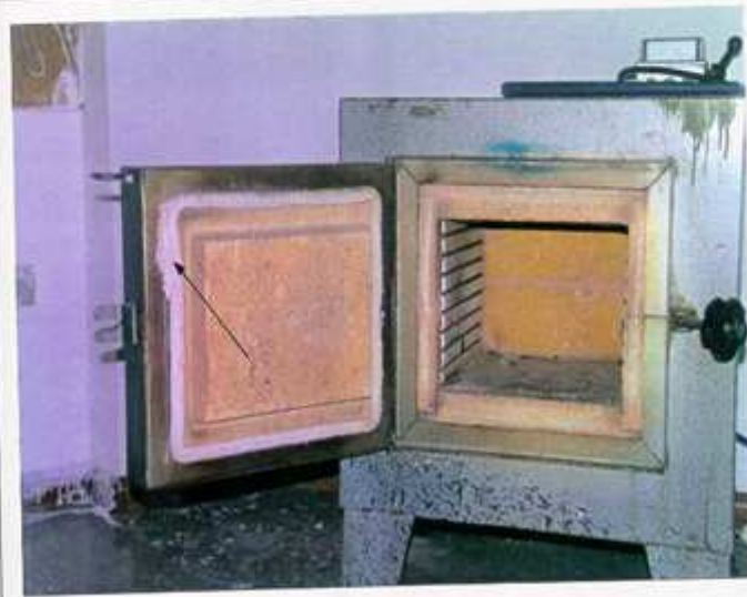
Foto 2: Mittelschule "Vigil Raber", Sterzing: Brennofendichtung
